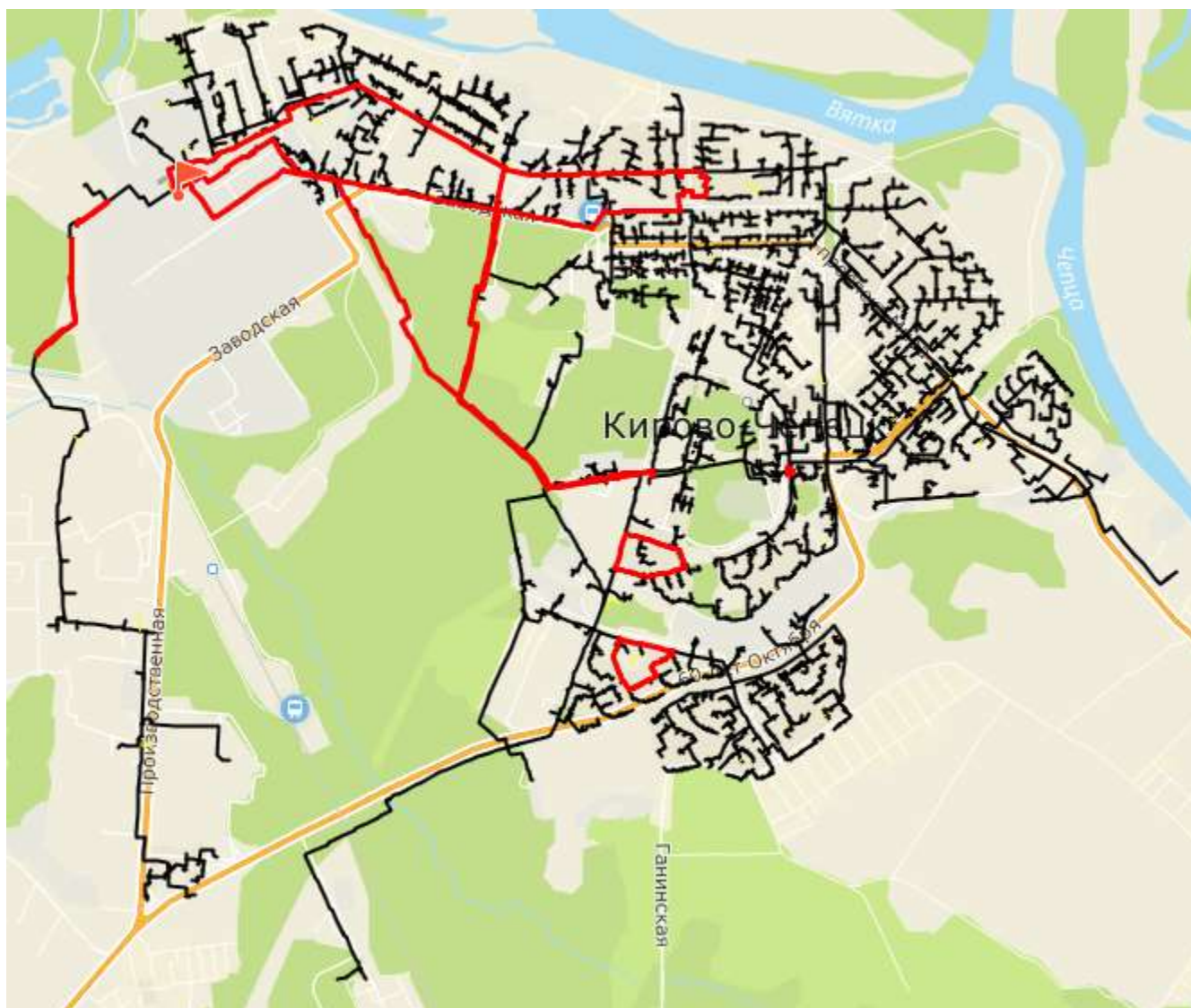
Рисунок 37 – Закольцовки тепловых сетей в зоне действия ТЭЦ-3
