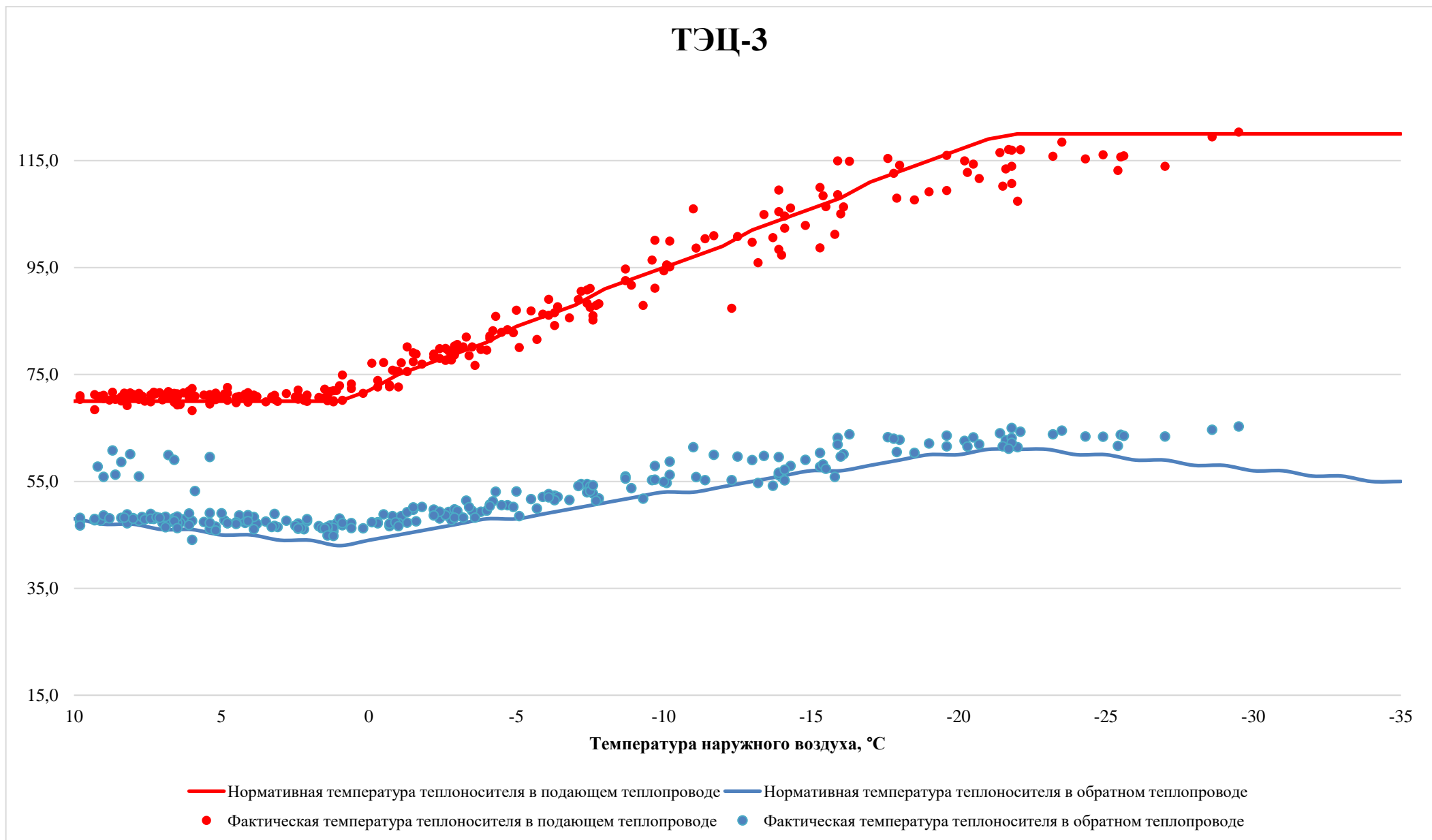
Рисунок 9 – Сравнение фактического графика изменения температуры теплоносителя от ТЭЦ-3 за 2021 г. и расчетного температурного графика
