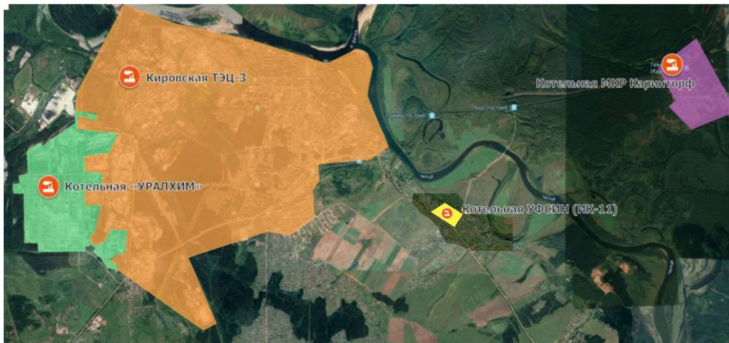
Рисунок 1 – Функциональная структура теплоснабжения города (адресная привязка на карте муниципального образования и зоны действия источников тепловой энергии)
